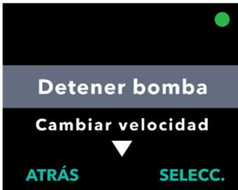
2. Si la bomba está en funcionamiento, pulse "SELECC." para acceder al menú *Detener bomba*.
